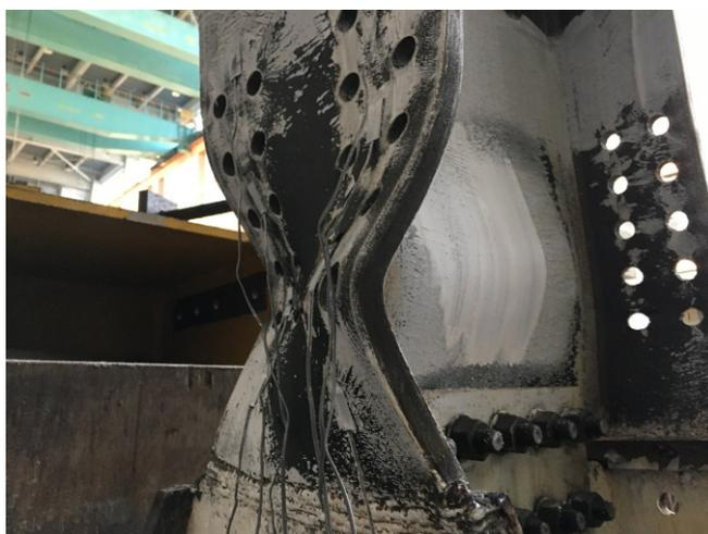
圖 9 試體 SB2 鋼梁翼板降伏挫屈 (DR = 6.0%)
