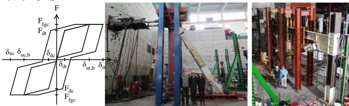
圖 1 高性能雙核心自復位斜撐行為及試體配置 (unit: mm)
