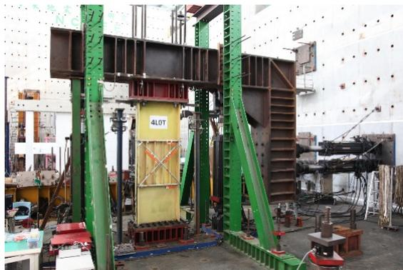
圖 2 4LOT 試體安裝配置情形
